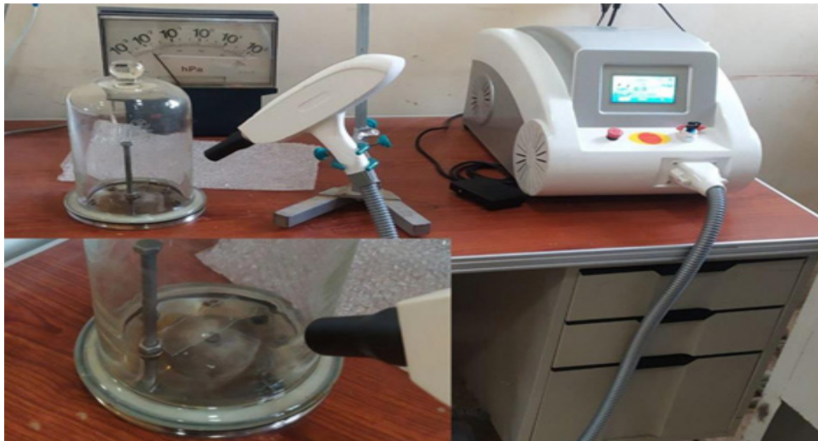
الشكل (1) : يبين صورة لحجرة الترسيب وجهاز الليزر المستخدم في ترسيب الأغشية .
