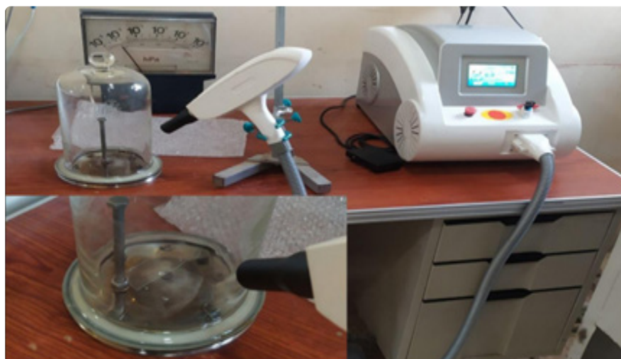
الشكل (2): يوضح مخطط لحجرة التسيب وجهاز الليزر المستخدم في ترسيب الاغشية.
