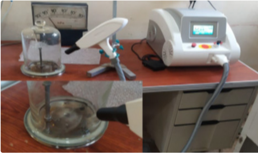
الشكل (1): يبين صورة لحجرة الترسيب و جهاز الليزر المستخدم في ترسيب الأغشية.
