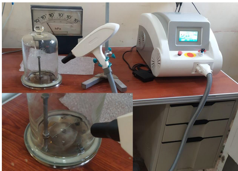
الشكل (1) يبين صورة لحجرة الترسيب و جهاز الليزر المستخدم في ترسيب الأغشية.
