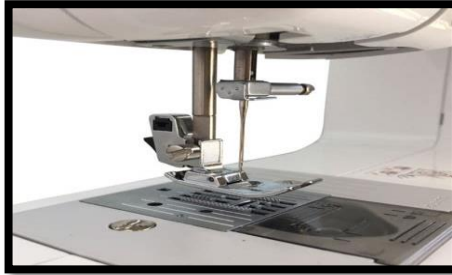
الأنموذج (١) - ماكينة نوع برذر مصممة وفق الحركة الترددية
