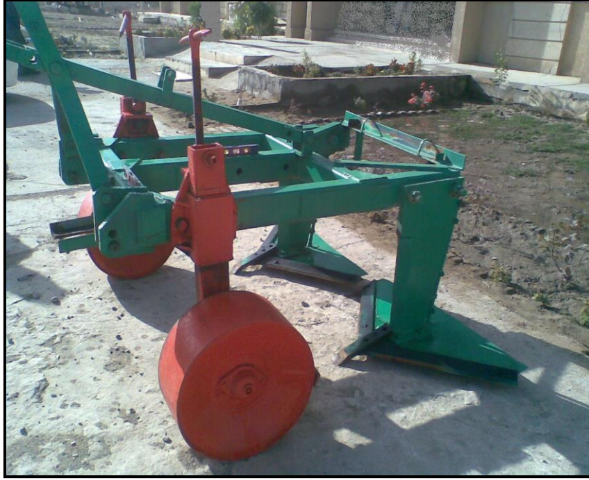
شكل 1: منظر جانبي للمحراث التحتي المحور محليا (Sweep plow) .
