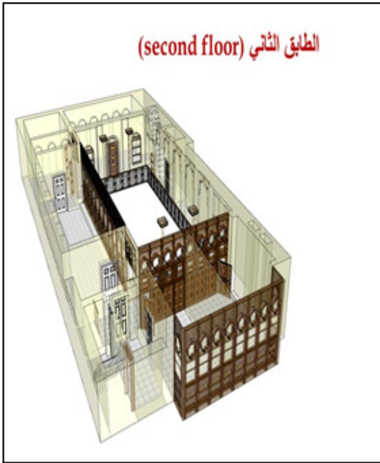
الشكل رقم (7) رفع معماري ثلاثي البعد للطابق العلوي لبيت طاوزند ببرنامج اوتوكاد، (طلاب جامعة واسط، كلية الهندسة/قسم هندسة العمارة، 2020).
