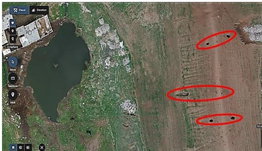
الشكل 6: الانفاق المحفورة حديثا، نظرة مقربة من صور الطائرة المسيرة بدقة تمييز 5 سم والتي من الصعب تمييزها في صور الاقمار الصناعية او حتى من النظر الافقي الارضي.
