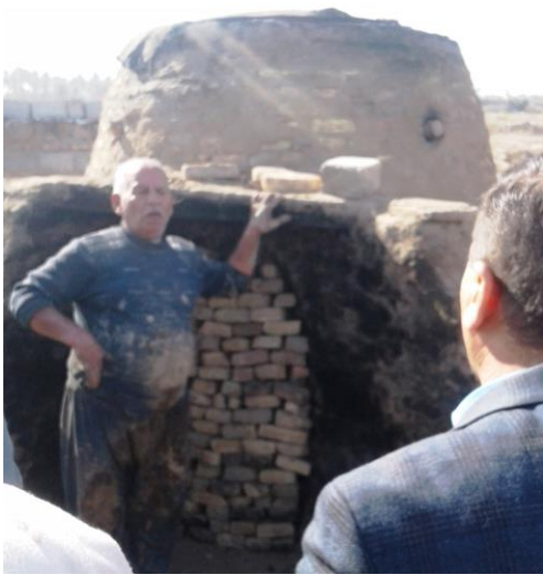
صورة رقم (٤) : صورته من تصوير الباحث تظهر طريقة غلق الفتحة المستخدمة لتنظيم وضعية الاواني الفخارية المصنوعة من الطين داخل الفرن بعد اكمال ملئ الفرن
