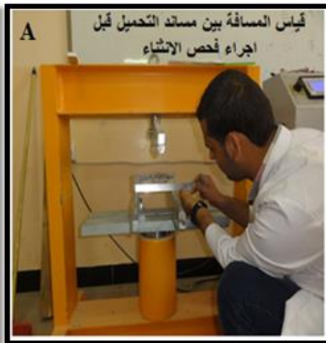
اللوحة (2) توضح عملية تهيئة وفحص مقاومة الانثناء لنماذج الحجر الرملي في منطقة الدراسة قبل الانهيار وبعد الانهيار.
