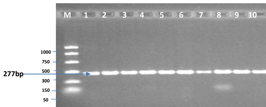
شكل (3-أ): التفاعل النهائي بعد تثبيت ظروف التفاعل للـ zein gene للعينات المستخلصة بواسطة High Pure GMO Sample Preparation Kit ، تمثل المسارات من 1 إلى 10 عينات محصول الذرة المستخدمة في هذه الدراسة ، المسار M: يمثل الدليل الحجمي Bench top PCR marker ، تركيز هلام الاكروز 2.5 % ، وقت الترحيل 2 ساعة .
