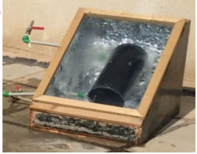
الشكل (2) المجمع الموشوري ذي قطع جزئي للمثلث القائم الزاوية
