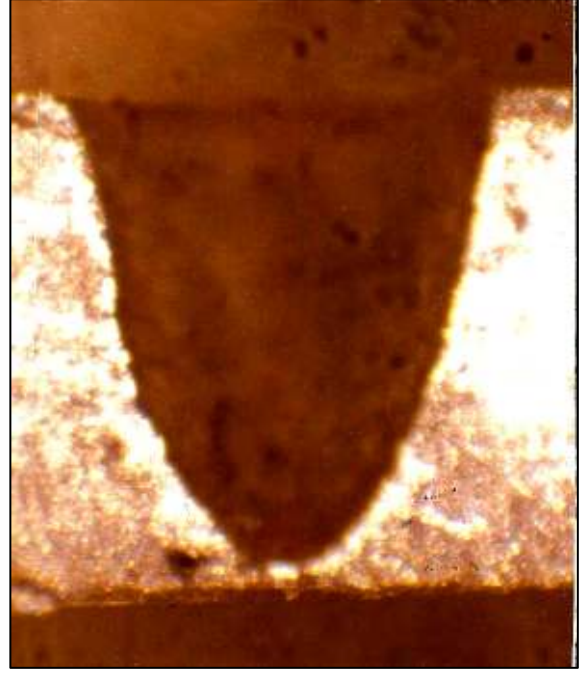
شكل (2) مقطع طولي لثقب في الفولاذ المقاوم للصدأ تحت تأثير الضغط الجوي
