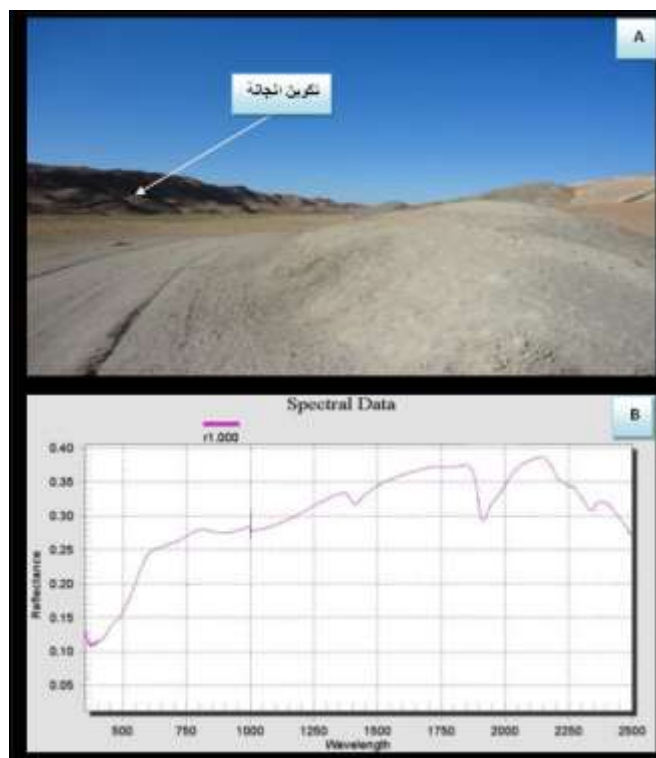
شكل (6) A - صورة لـصخور الـ Sandstone في تكوين انجانة. B - منحنى الانعكاسية الطيفية في تكوين انجانة
