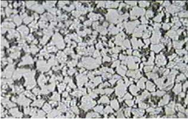
شكل-٥: البنية المجهرية للفولاذ المخمر عند 850°C (230X)
