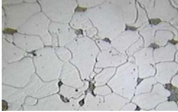
شكل-٦: البنية المجهرية للفولاذ المخمر عند 1000°C (230X)
