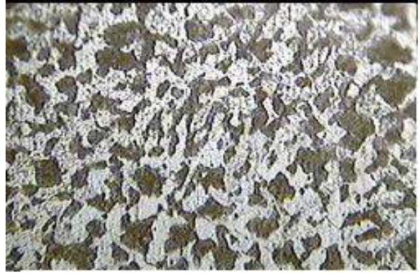
شكل-٤: البنية المجهرية للفولاذ بحالته المستلمه (230X)
