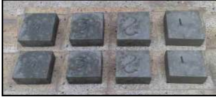
شكل رقم (٢) يوضح النماذج الخرسانية المعدة لفحص الموصلية الحرارية
