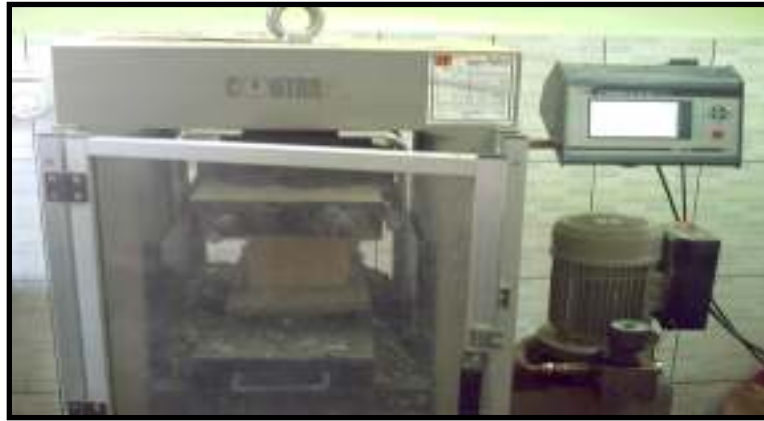
شكل رقم (٥) يوضح الجهاز المستخدم لفحص مقاومة الإنضغاط للخرسانة
