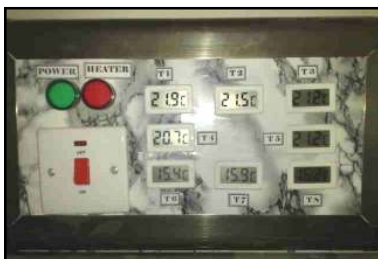
شكل رقم (٧) يوضح تفاصيل اللوحة الإلكترونية الخاصة بجهاز قياس الموصلية الحرارية
