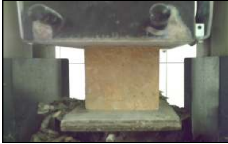
شكل رقم (٣) يوضح مكعب خرساني قياسي معد لفحص مقاومة الإنضغاط
