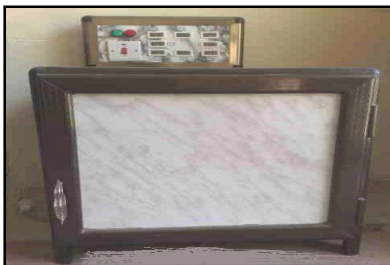
شكل رقم (٦) يوضح الجهاز المستخدم لقياس الموصلية الحرارية للخرسانة
