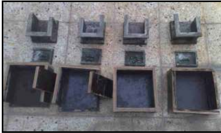
شكل رقم (١) يوضح القوالب الخشبية للنماذج والقوالب الفولاذية للمكعبات الخرسانية
