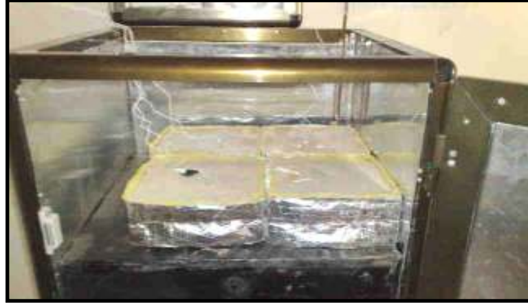
شكل رقم (٨) يوضح نماذج خرسانية داخل حجرة جهاز قياس الموصلية الحرارية
