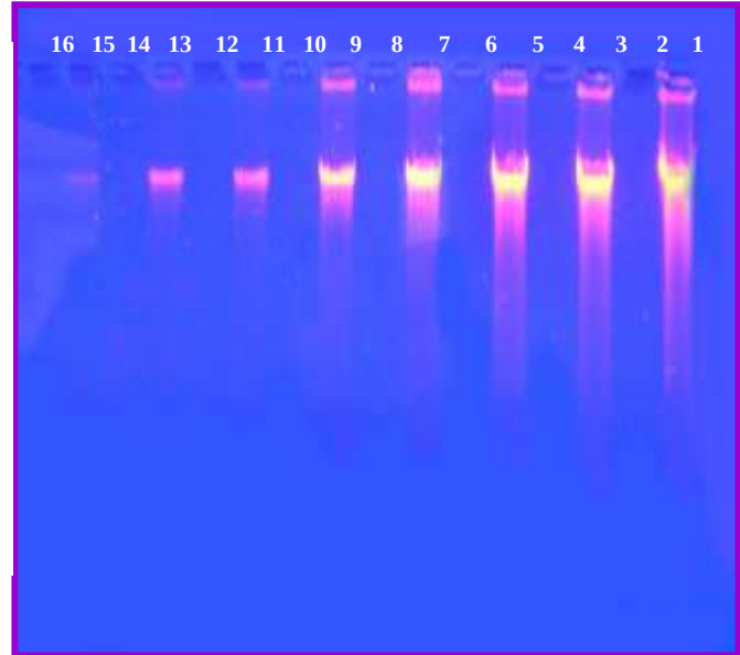
شكل ( 4 ) : الترحيل الكهربائي لنواتج تفاعل الانزيم المنقى جزئياً مع المادة الاساس لتحديد التركيز الامثل لها على هلام الاكاروز بتركيز 0.8% بفرق جهد 65 فولت ولمدة 1.5 ساعة
