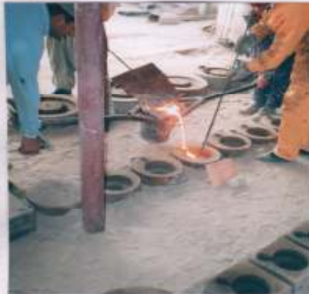
شكل (٣) صورة فوتوغرافية لعملية الصب والبوتقة والحامل الحديدي
