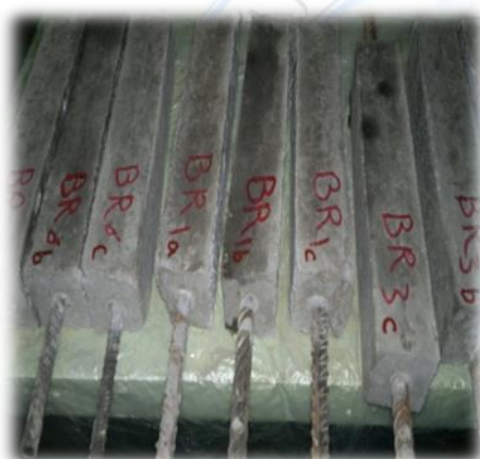
شكل (٢) يوضح النماذج الخرسانية المسلحة المستخدمة
