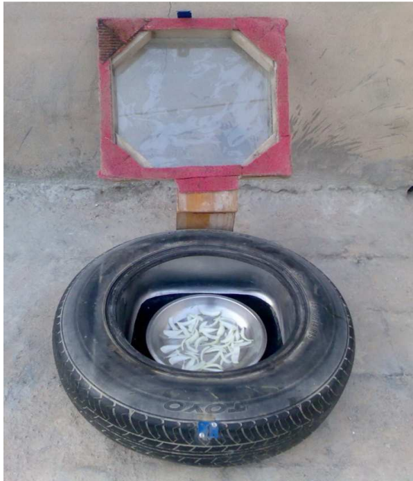
شكل 1: صورتان فوتوغرافيتان للمجفف الشمسي المصنع محليا.
