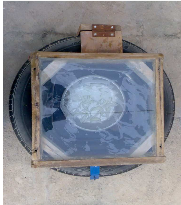
شكل 1: صورتان فوتوغرافيتان للمجفف الشمسي المصنع محليا.
