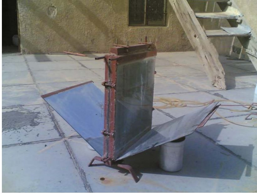
شكل (2) صورة فوتوغرافية توضح المقطر الشمسي العمودي مع المرآة العاكسة من الجانبين
