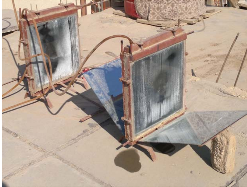
شكل (3) صورة فوتوغرافية توضح تشغيل المقطرين الشمسيين العموديين
