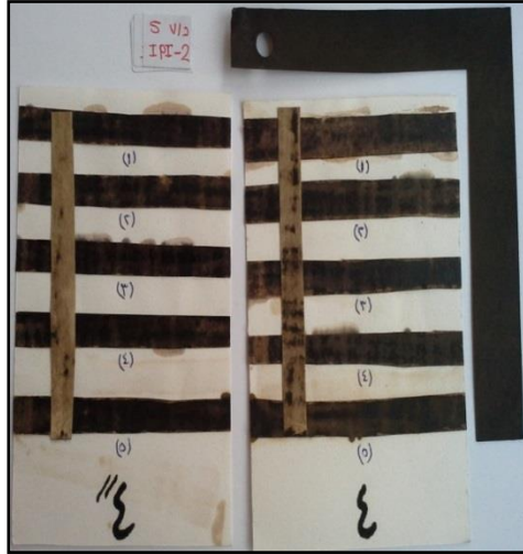
صورة رقم (١١) حبر بيروجالات الحديد المكشوط والممسوح بعد الترميم والإنعاش بمحاليل العلاج الخمسة مقارنة بأشروته غير المعالجة
