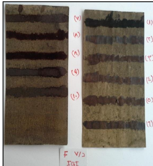
صورة رقم (١) حبر العفص الحديدي الباهت قبل وبعد إنعاشه بمحاليل الدراسة العشرة في شكل خطوط
