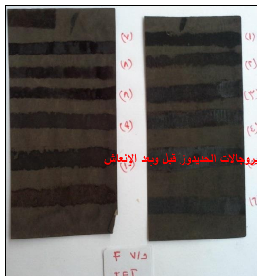
صورة رقم (٥) حبر الإيجيتانات الحديد قبل وبعد الانعاش بمحاليل الدراسة العشرة في شكل خطوط
