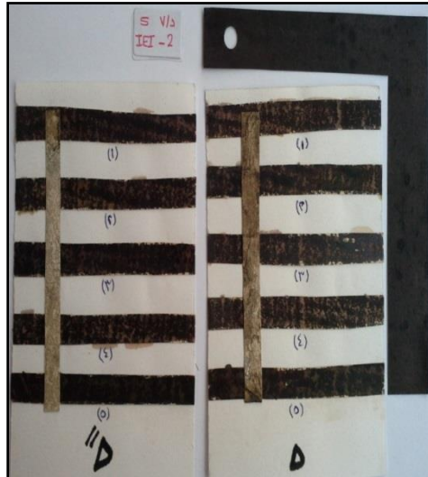
صورة رقم (١٢) حبر إلاجيتانات الحديد المكشوط والممسوح بعد الترميم والإنعاش بمحاليل العلاج الخمسة مقارنة بغير المعالجة
