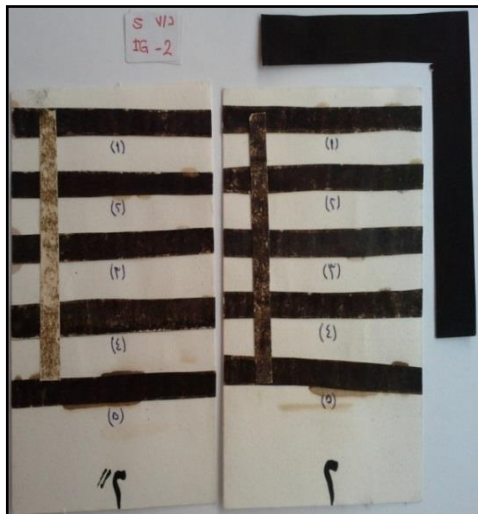
صورة رقم (٩) حبر جالات الحديد المكشوط والممسوح بعد الترميم والإنعاش بمحاليل العفص، الإهليلج، حامض التانيك، حامض العفصيك والبيروجالول مقارنة بأشهرته غير المعالجة
