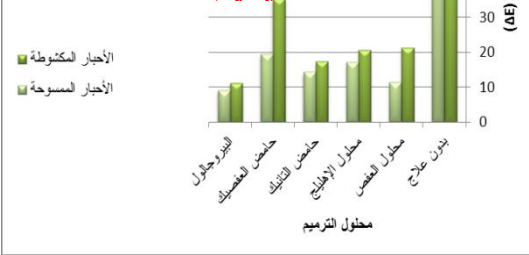
صورة رقم (٨) حبر العفص الحديدي المكشوط والممسوح بعد الترميم والإنعاش بمحاليل العفص، الإهليلج، حامض التانيك، حامض العفصيك والإهليلج مقارنة بأشهرته غير
