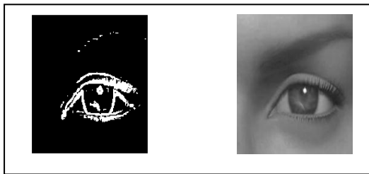
شكل (١) يوضح الصورة الأصلية وكاشف الحافة لها.
